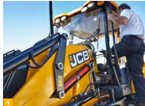
**2** Многослойное лобовое стекло и применение высокопрочного плоского стекла в других компонентах обеспечивают защиту оператора, в том числе при работе с навесным оборудованием. Замена стекол осуществляется быстро и легко, что также сокращает простои.
